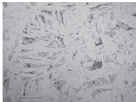
Рис. 3. Основная структура образца 3 катанки из стали Св-10ГАА ( t = 650\text{ }^{\circ}\text{C} , \tau = 30\text{ мин} ). \times 50
