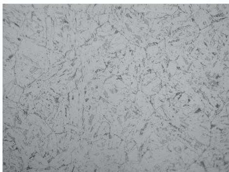
Рис. 4. Основная структура образца 4 катанки из стали Св-10ГАА ( t = 550\text{ }^{\circ}\text{C} , \tau = 20\text{ мин} ). \times 50
