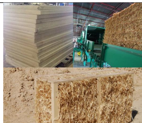
Рисунок 8. Древесноволокнистые плиты CAFboard (Compressed Agricultural Fiber Board)
