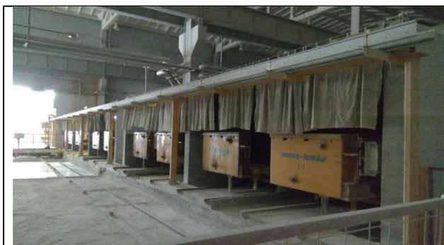
Рисунок 17. Линия производства силикатных блоков (фото из личного архива)
