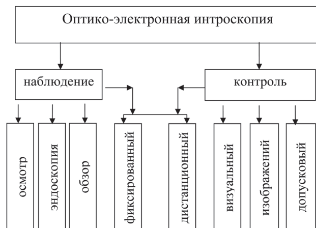
Рис. 2. Структура оптико-электронной интроскопии
