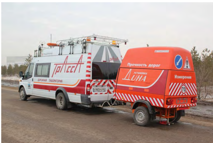
Рисунок 2 – Дорожная лаборатория «Трасса» на базе микроавтобуса Ford Transit с модулями: профилометр, видеосъемка, GPS и прицепом «Дина» для динамического измерения упругого прогиба
