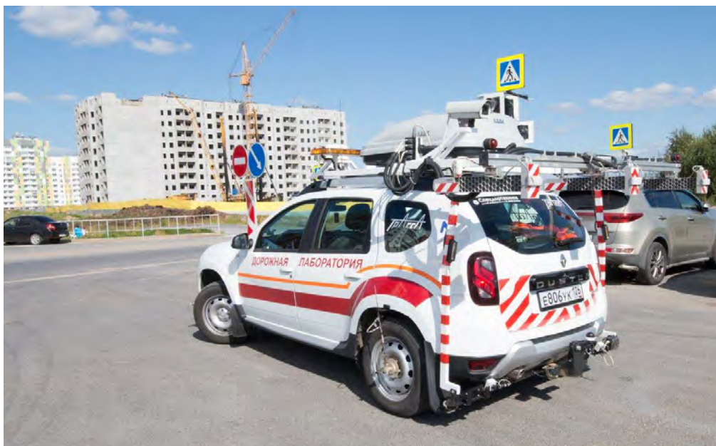
Рисунок 3 – Дорожная лаборатория «Трасса» на базе легкого автомобиля Reno Duster с модулями: профилометр, видеосъемка и GPS.
