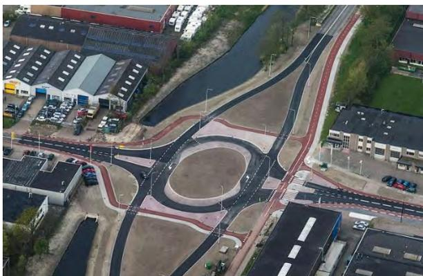
Рисунок 5 – Применение кольцевой развязки для регулирования автомобильного и велосипедного движения [5]
