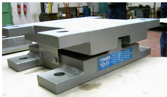
Рисунок 9 – Собранный сдвиговой упор Reston-Force на заводе Источник: https://www.mageba-russia.ru
