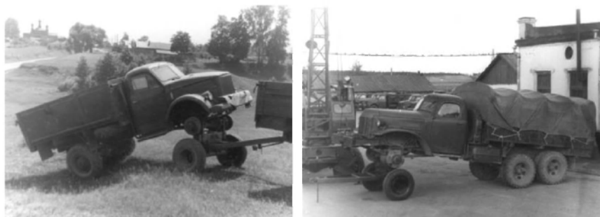
Рис. 1.7. Способ эвакуации неисправного автомобиля частичной погрузкой па подкатную тележку
