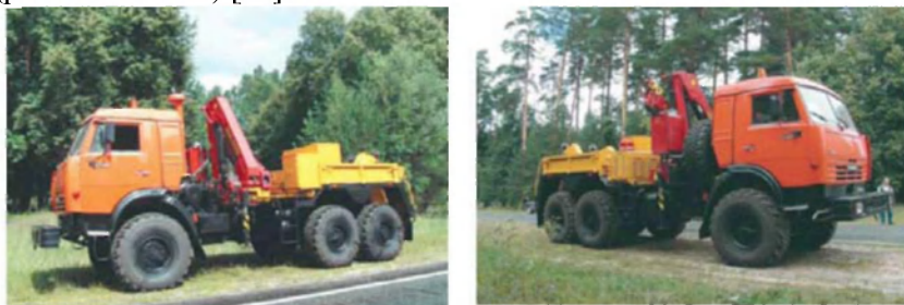
Рис. 3.15. Машины технической помощи МТП-А2.2-000 и МТП-А2.2-001
