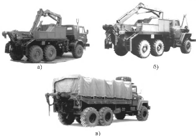
Рис. 1.5. Специализированные эвакуаторы (машины технической помощи), разрабатываемые и серийно изготавливаемые Российской Федерацией для нужд армии:
