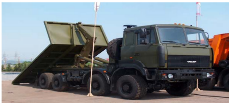
Рис. 4.6. Тягач МЗКТ-73011, оборудованный системой мультилифт МПР-2
