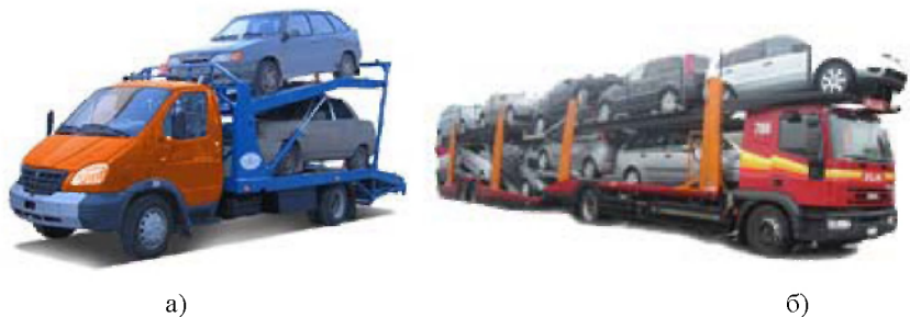
Рис. 1.15. Двухэтажные эвакуаторы: а) эвакуация двух машин; б) эвакуация более трех автомобилей
