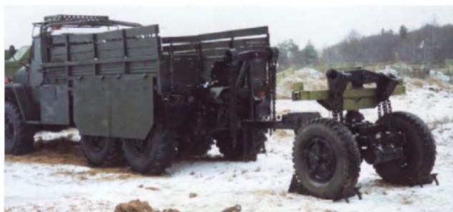
Рис. 1.8. Буксирный прицеп, обеспечивающий погрузку неисправного автомобиля за счёт возможности складывания дрышла прицепа в вертикальной плоскости силой тяги автомобиля – тягача
