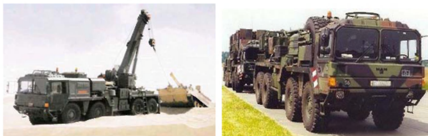
Рис. 3.44. Тяжелый ремонтно-эвакуационный автомобиль FAUN ВКФ-30.40 8x8.1 при эвакуации танка и при буксировке техники
