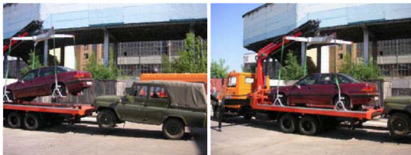
Рис. 1.16. Эвакуатор, способный эвакуировать два автомобиля одновременно
