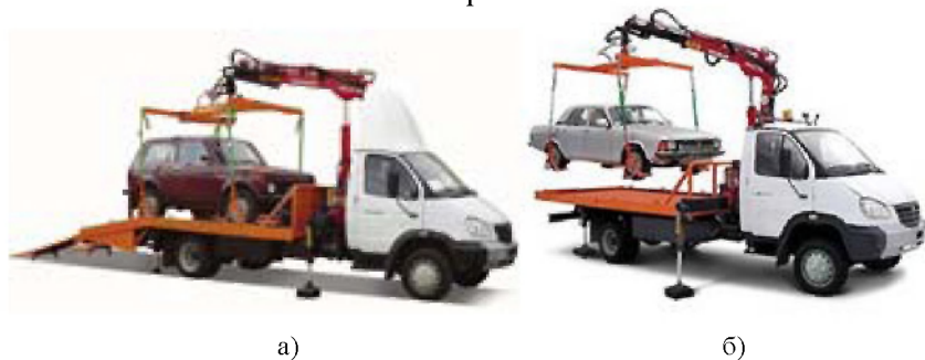
Рис. 1.12. Эвакуаторы с гидроманипулятором: а) – с ломаной платформой; б) – с прямой платформой
