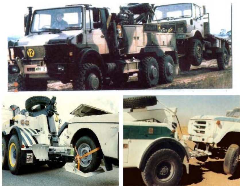
Рис. 1.4. Эвакуация неисправных автомобилей специальными эвакуаторами, оборудованными грузоподъемными, захватными и фиксирующими устройствами
