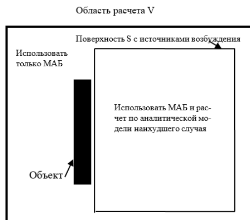
Рисунок 1 – Графическая демонстрация предлагаемого принципа объединения аналитических моделей наихудшего случая и метода минимальных автономных блоков
