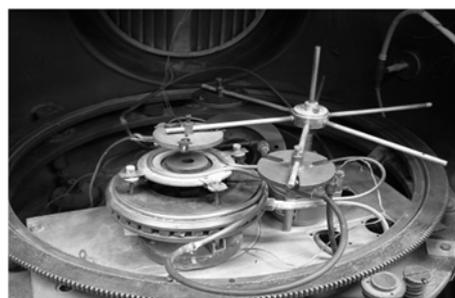
Рисунок 1 – Внешний вид внутрикопачного объема установки ВУ-1А
