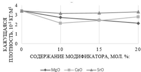
Рисунок 3– Зависимость кажущейся плотности от содержания модификатора
