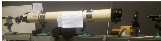
Рисунок 1 – Общий вид экспериментального стенда для контроля фокусного расстояния
