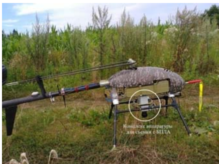
Рисунок 2 – БПЛА UVH-25EL с установленным АМСС-1 перед вылетом
