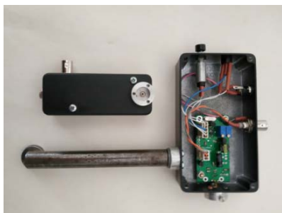
Рисунок 1 – Внешний вид диодных лазеров в различных металлических корпусах
