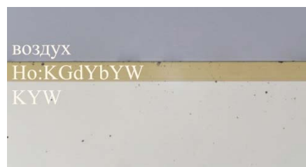
Рисунок 1 – Фотография монокристаллического слоя, активированного ионами гольмия, выращенного на кристалле \text{KY}(\text{WO}_4)_2
