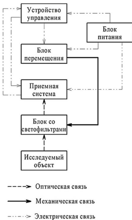
Рисунок 1 – Функциональная схема макета МСВ
