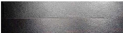
Рисунок 1 – Полученный образец полутонного клина на кварцевом стекле
