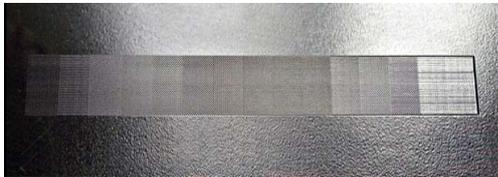
Рисунок 2 – Полученный образец полутонного клина на органическом стекле
