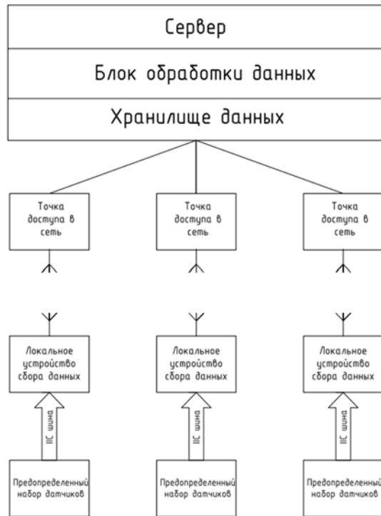
Рисунок 1 – Структурная схема системы мониторинга параметров окружающей среды в мегаполисе
