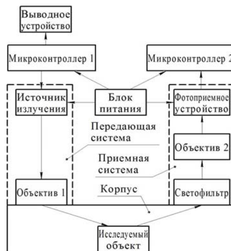
Рисунок 1 – Функциональная схема макета стенда для измерения ЭПО
