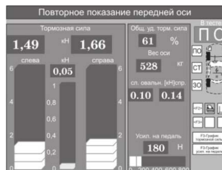
Рисунок 2 – Данные контроля тормозной системы автомобиля:
