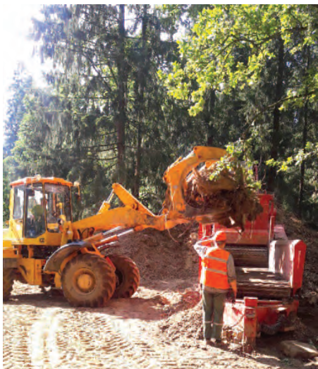
Рис. 5. Подача выкорчеванных пней к рубильной машине
