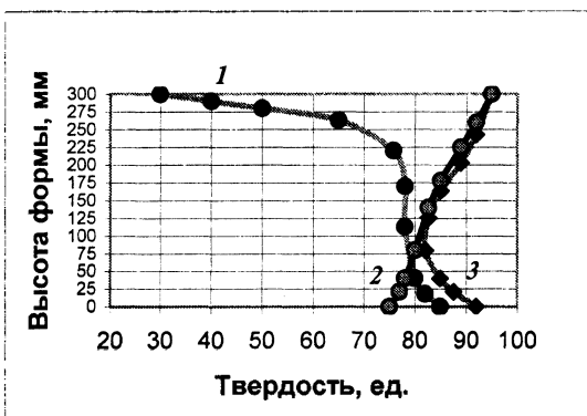
Рис. 1. Распределение твердости формовочной смеси по высоте формы после уплотнения: 1 – пневмопотокм; 2 – прессованием; 3 – пневмопотокм с последующим прессованием
