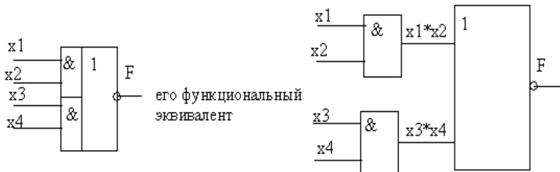
Рисунок 7.14 Условное обозначение и функциональный эквивалент элемента «2И-ИЛИ-НЕ»
