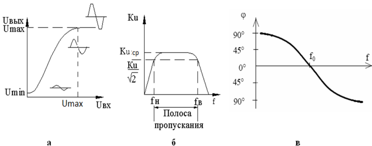
Рисунок 6.15 Характеристики усилителя: а – амплитудная; б – амплитудно-частотная; в – фазо-частотная
