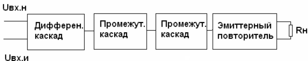
Рисунок 6.21 Структурная схема ОУ
