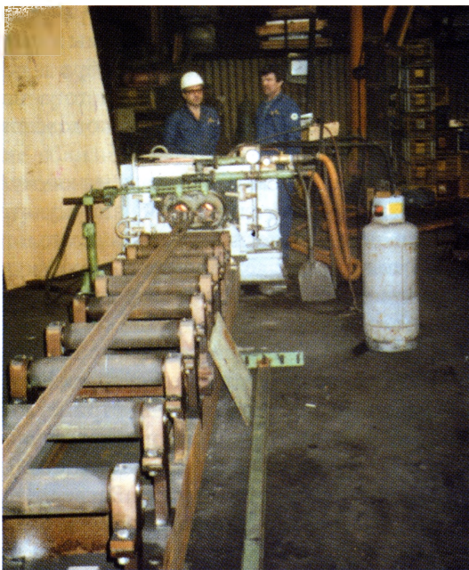
Рис. 3. Установка горизонтального литья на фирме "Sam Chang"
