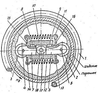
Изобретение относится к порошковой металлургии, в частности к устройствам для нанесения покрытий из металлических порошков на внутренние поверхности изделий.
