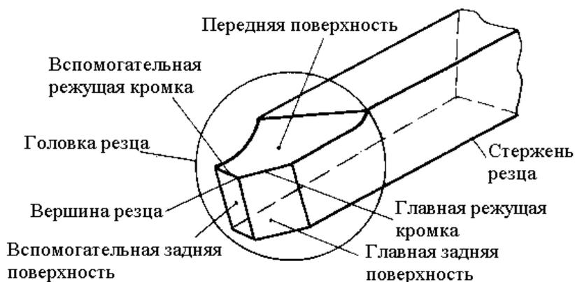
Рис. 1.3 – Элементы токарного резца.
