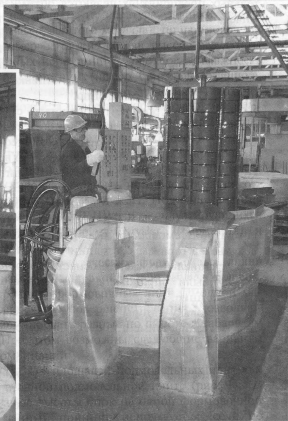
▲ Операция замочки в масле после нитрирования
