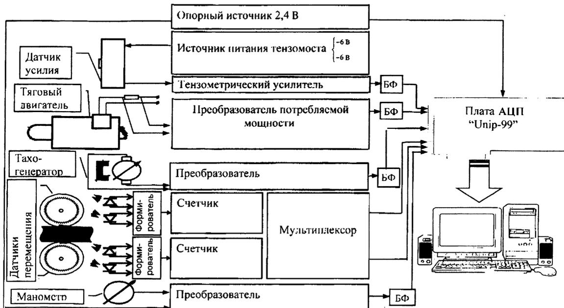
Схема измерительной системы
