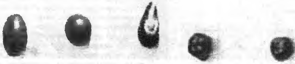
Рис. 2. Форма стальных литых дробинок, выплавляемых в СЛЦ-2 МАЗ (а) и производства фирмы "Wheelabrator Allevard" диаметром 2,2 мм (б)
