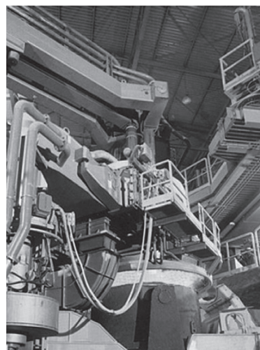
Рис. 8. Установка «ковш-печь» (масса плавки – 140 т, мощность – 20 МВА, максимальная скорость нагрева – 5–6 град/мин)
