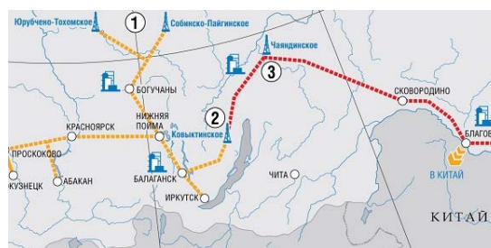
Рис. 6. Предлагаемая схема развития электрических сетей Забайкальского региона
