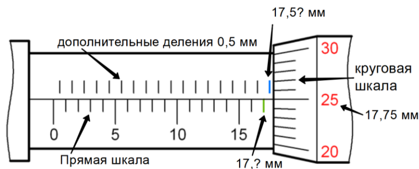
Рисунок 4 – Схема снятия показаний по шкалам микрометра
