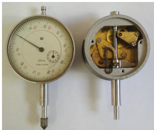
Рисунок 5 – Индикатор часового типа (ИЧ) и его внутренне устройство со снятой задней крышкой
