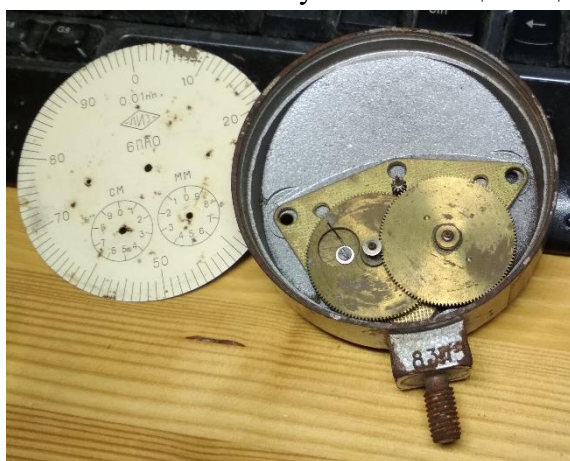
Рисунок 10 – Внутренне устройство прогибомера Аистова
