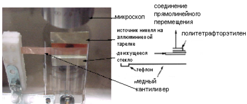
Рисунок 1 - Медная консоль с нанесенным слоем металла Ni-63
