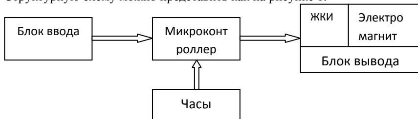
Рисунок 1 – Структурная схема кодового замка.
