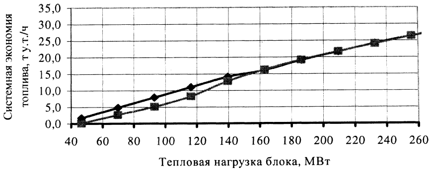
Рис. 3. Экономия топлива в энергосистеме в зависимости от тепловой нагрузки блока 180 МВт: —◆— электрический; —■— тепловой графики
