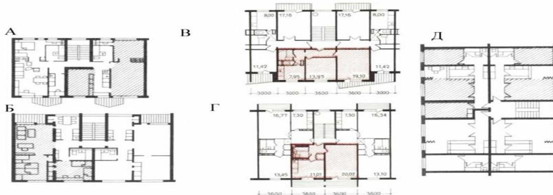
Рис.4.3. Ориентация секций по странам света: А, Б - неограниченная ориентация (широтная секция), В, Г- частично ограниченная (широтная секция), Д-ограниченная ориентация (меридиональная секция).
