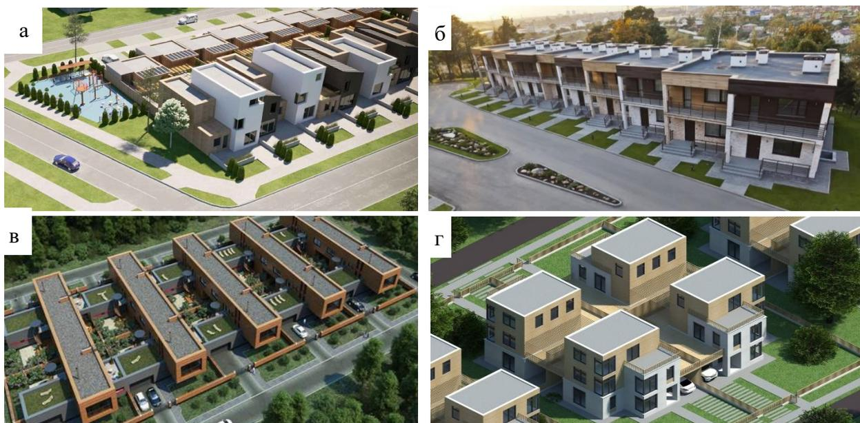
Рис.3.5. Блокированные жилые дома: линейная однорядная(а), двухрядная(б); со сдвигом(в); с расположением между блоками хозяйственных пристроек(г).
