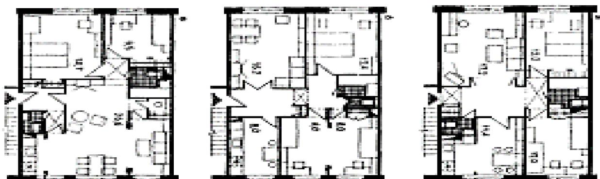
Рис.2.2. Примеры вариантной планировки квартир.
