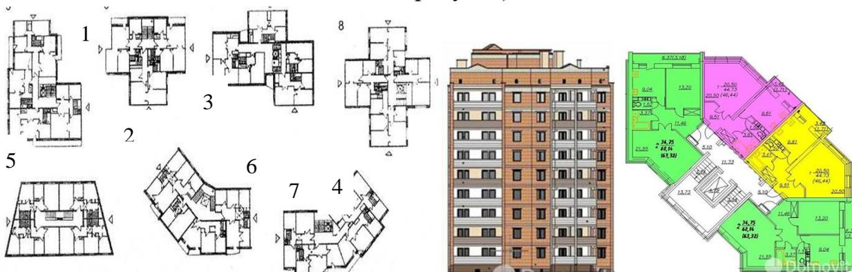
Рис.4.6. Поворотные секции различной конфигурации, жилой дом в Полоцке
