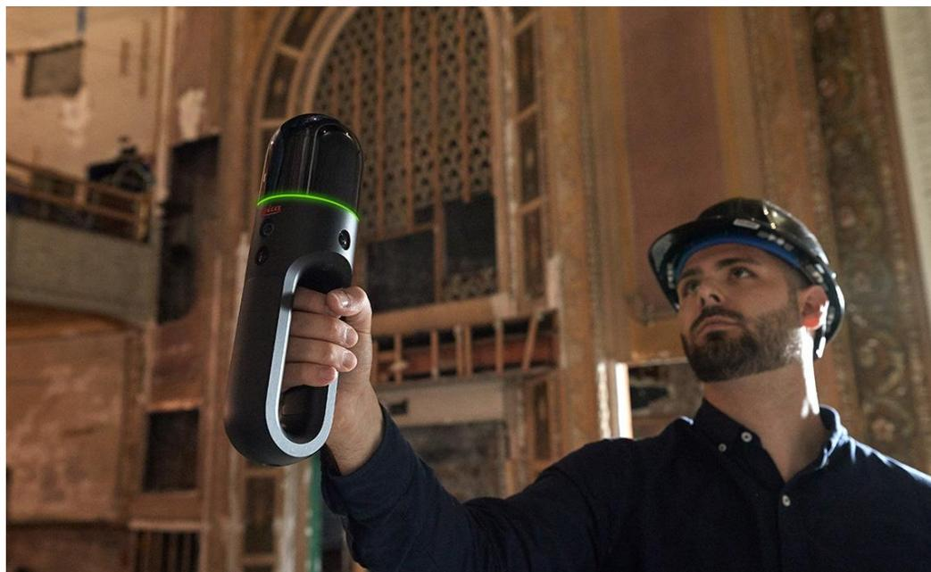
Рисунок 9.14. - Портативный сканер Leica BLK2Go
