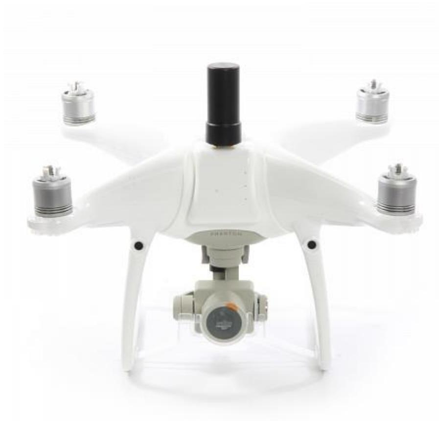
Рисунок 9.8. - Дрон DJI Phantom 4 Pro v2.0 L1/L2 RTK/PPK
