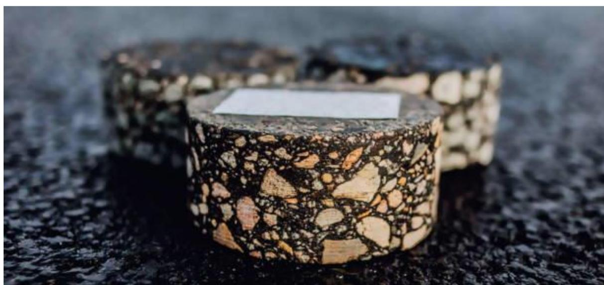
Рисунок 4.4. – Покрытие с улучшенными эксплуатационными характеристиками
