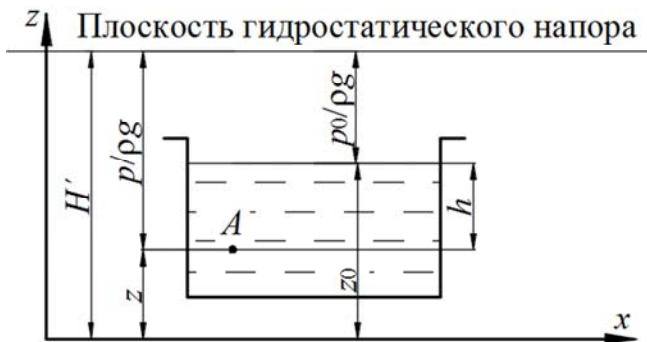
Рис. 5. Схема к выводу основного уравнения гидростатики
