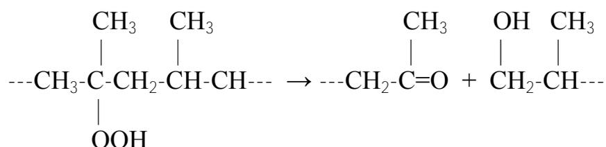
Образование новых кислородсодержащих функциональных групп сопровождается разрывом полимерной цепи на более мелкие фрагменты.
