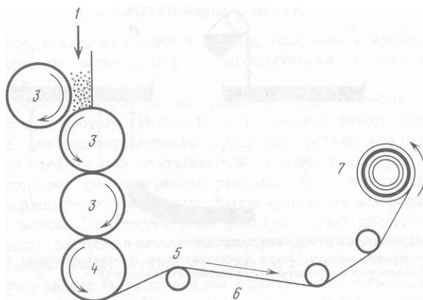
Рис. 14.3. Схема аппарата для каландрования:
