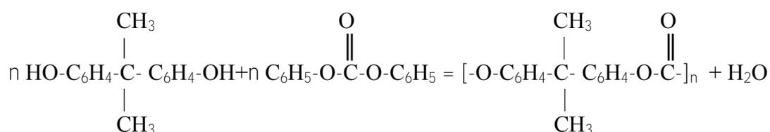
Поликарбонаты плавятся при 265<sup>0</sup>С и имеют очень высокую ударную прочность. Полимер представляет собой прозрачный пластик. Из него изготавливают защитные очки и экраны, прозрачные строительные материалы.
