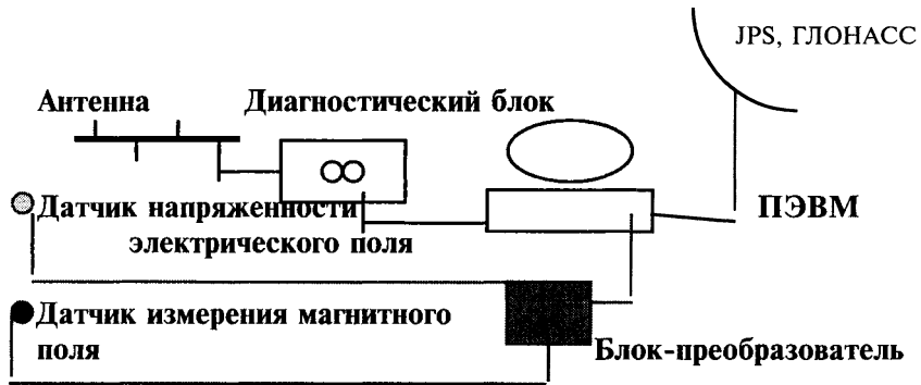
Рис. 3. Структурная схема диагностической системы ВЛ
