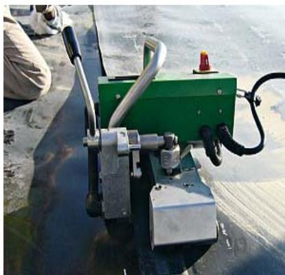
Рис. 5А. Сварочный автомат горячего клина «Astro» для сваривания швов на скорости 5 м/мин
