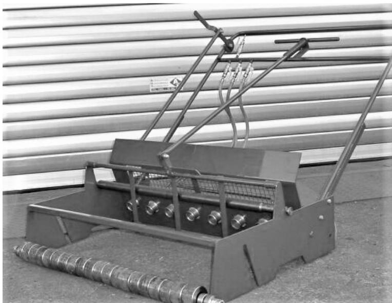
Рис. 13А. Машина СО-121А для сварки рулонных материалов
