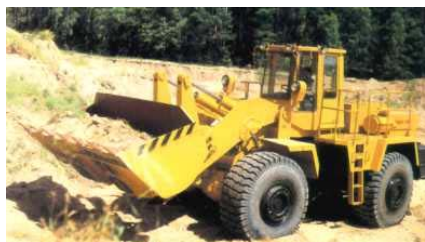
Рисунок 1 – МоА3-40483 (40484) с колесной формулой 4×4
