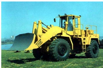
Рисунок 2 а – МоА3-40484-025 с колесной формулой 4×4
