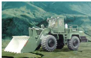
Рисунок 2 б – МоА3-40484-025 с колесной формулой 4×4
