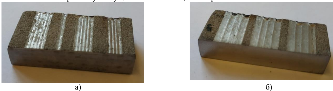
Рисунок 1 – Внешний вид лазерных дорожек бронзового покрытия при диаметре лазерного луча: а) 1 мм, б) 3 мм
