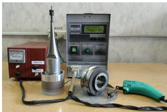
Рисунок 1 – Комбинированная установка для осуществления ЭИЛ с УЗВ
