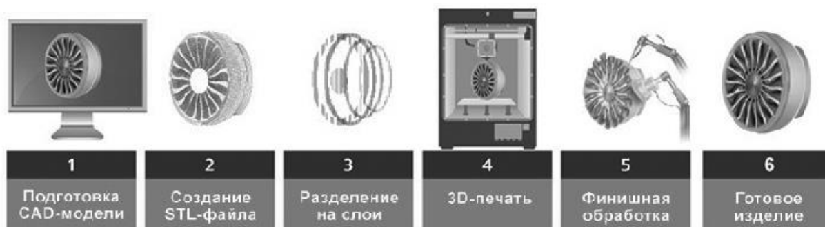
Рисунок 5 – Последовательность производства изделий аддитивным методом
