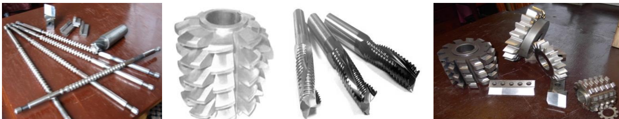
Рисунок 3 – Металлорежущие инструменты с покрытием, полученным методом ЭИЛ с УЗВ
