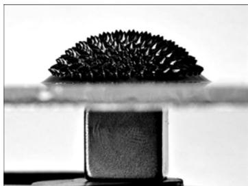
Ферромагнитная жидкость - жидкость, сильно поляризуемая в присутствии магнитного поля.
