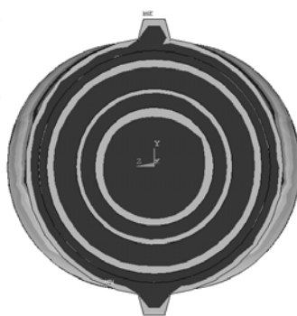
Рисунок 21 – Деформации в осевом направлении образца (серый цвет – предельные значения, напряжения 350 МПа)
