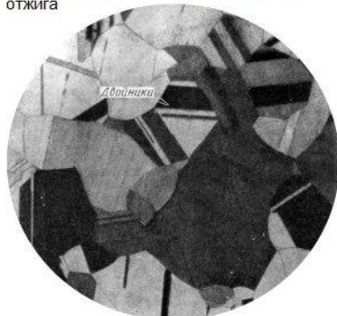
Рисунок 5. Микроструктура однофазной (а) и двухфазной (б) латуни
