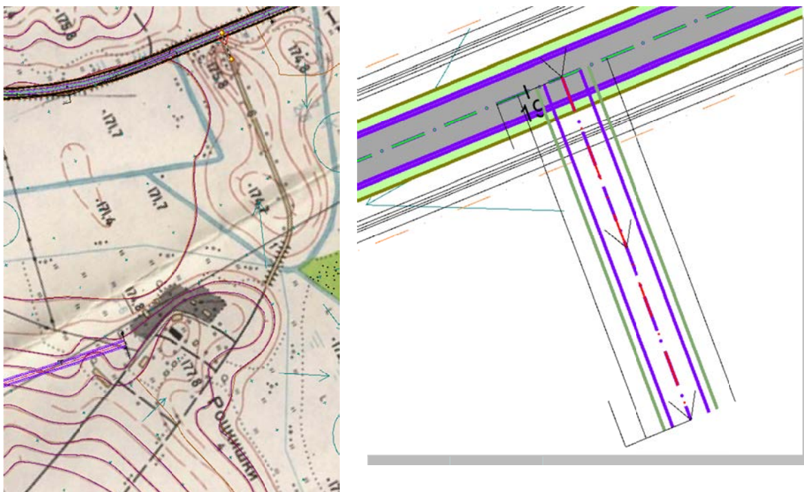
Рис. 4.4. Создание второстепенной трассы (ВТ)
