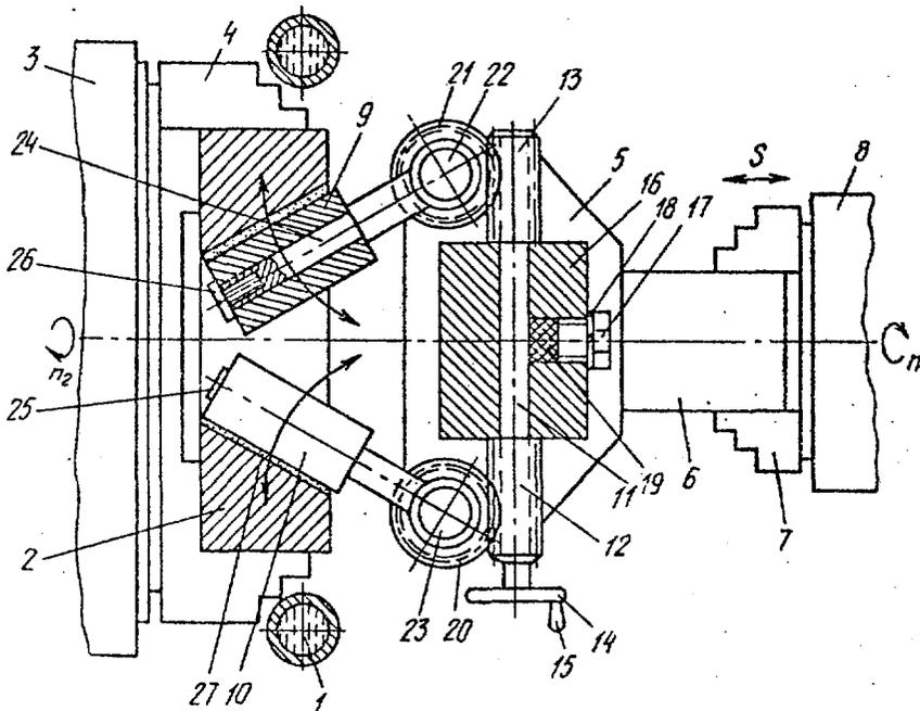
Изобретение относится к порошковой металлургии, а именно к устройствам для нанесения металлических твердосплавных покрытий на внутренние конические поверхности деталей – тел вращения.
